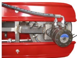
Fig. 3 Applicazione con motore idraulico
