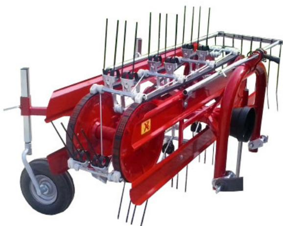
Abb. 1 Bandschwader T 16 mit heuschutz mit Zähnen
