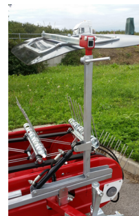
Fig. 2 Dettaglio gruppo montante con ruota e leva di registrazione dell'altezza Upright group detail with wheel and height adjusting lever
