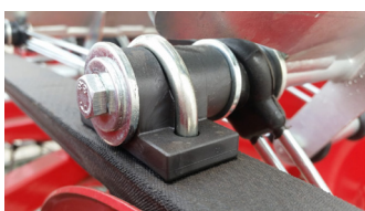
Abb. 3 Detail der Halterung und der Buchsen aus selbstschmierendem Material
